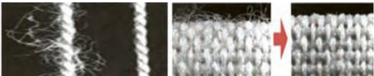
پرزهای سطح پارچه و نخ قبل از پرزسوزی و بعد از پرزسوزی
